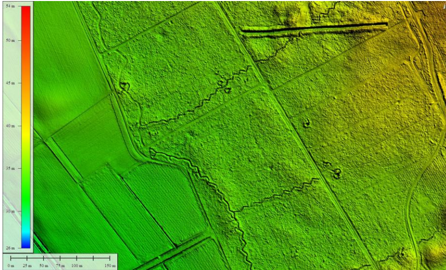
Figuur 5. Lidar-hoogtemodel van loopgraven (zig-zag-patronen) en een tank-greppel uit de Tweede Wereldoorlog in Limburg. De individuele laserpunten zijn omgezet naar een regelmatig raster van 50 cm x 50 cm. Rastercellen zonder laserpunten zijn opgevuld op basis van de hoogten van cellen in de omgeving (bron: AHN-2, nauwkeurigheid voldoet aan de hierboven genoemde systematische en stochastische fouten).
